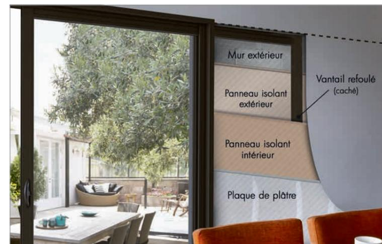
Un galandage robuste et isolant (avec 2 panneaux isolants intégrés en option).
